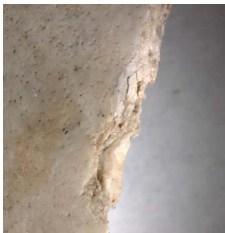
Fotografías 5 – 6. Detalles de la superficie de fractura (Fotomacroscopio 6,3x)
