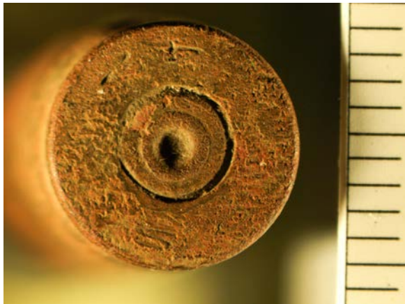
Fotografía 40. Aspecto del culote disparado al estereomicroscopio.
